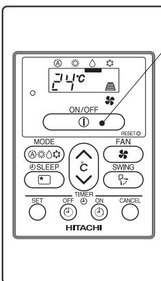
Установите желаемую температуру в помещении, воспользовавшись кнопками настройки ТЕМПЕРАТУРЫ (настройка отображается на дисплее).
