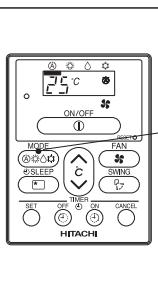
Prima o botão selector de MODO para que o visor indique o modo de funcionamento **A** (AUTOMÁTICO).
