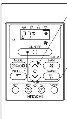
Drücken Sie die Taste ① (START/STOPP). Kühlbetrieb startet. Drücken Sie die Taste erneut, um das Gerät anzuhalten. Die Kühlfunktion wird nicht gestartet, wenn die Temperatureinstellung über der aktuellen Raumtemperatur liegt (auch wenn die BETRIEBSANZEIGE ① leuchtet). Der Kühlbetrieb wird gestartet, sobald der Benutzer eine Temperatureinstellung unter der aktuellen Raumtemperatur wählt.
