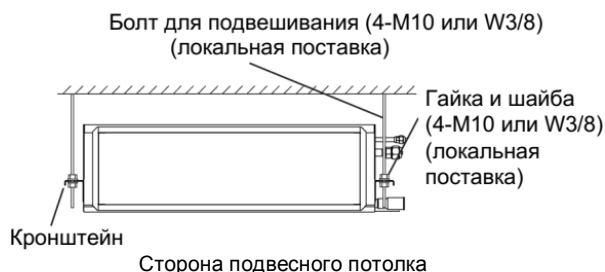
Рисунок 4.4. Монтаж внутреннего блока.
