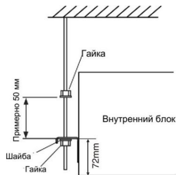
Рисунок 4.5. Подвесные болты (шпильки) и гайки.
